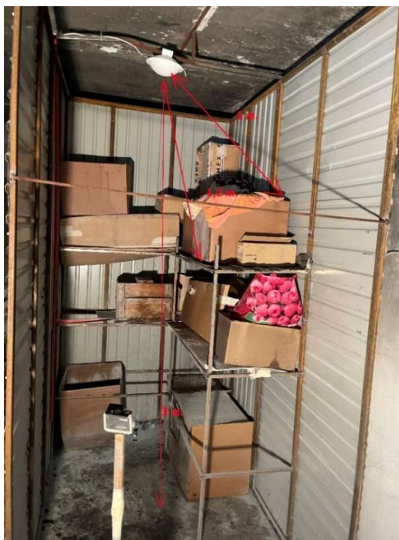
Рис. 11 Общий вид монтажа с размерами для проведения натурального испытания.
