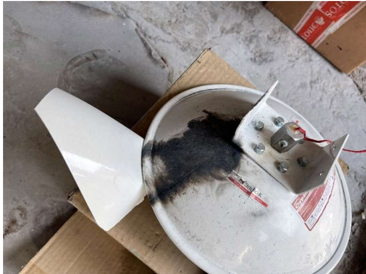
Рис. 12. Место локального обгорания верхней полусферы модуля.
