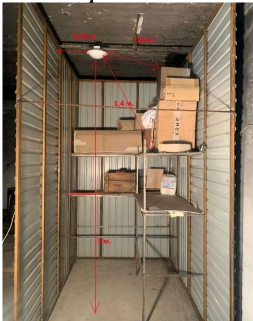
Рис. 9 Общий вид монтажа с размерами для проведения натурального испытания
