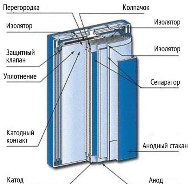
Рис 2. Устройство призматического литий – ионного аккумулятора.
