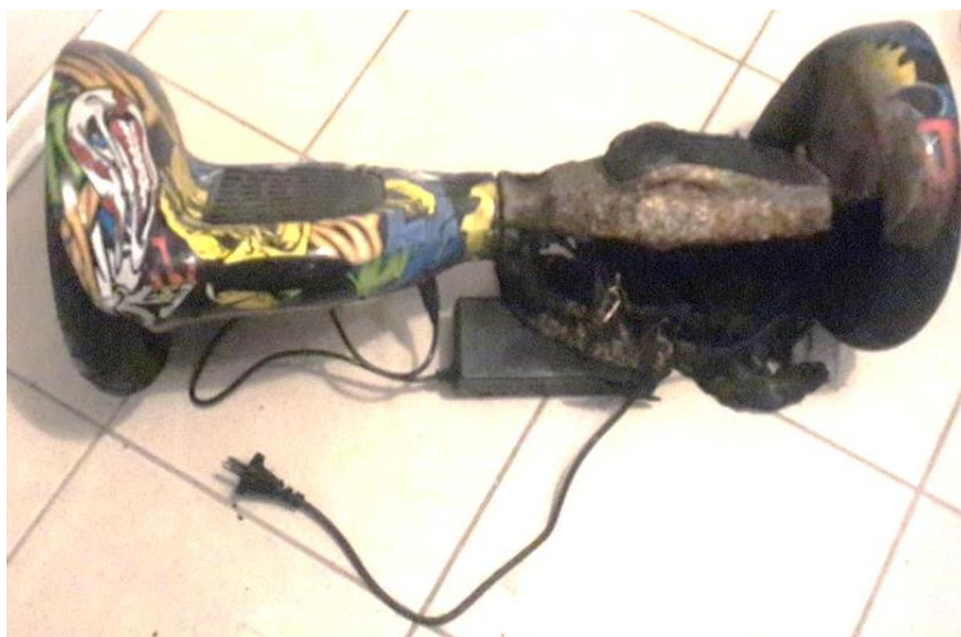
Фото 3. Общий вид гироскутера со следами термических повреждений.
