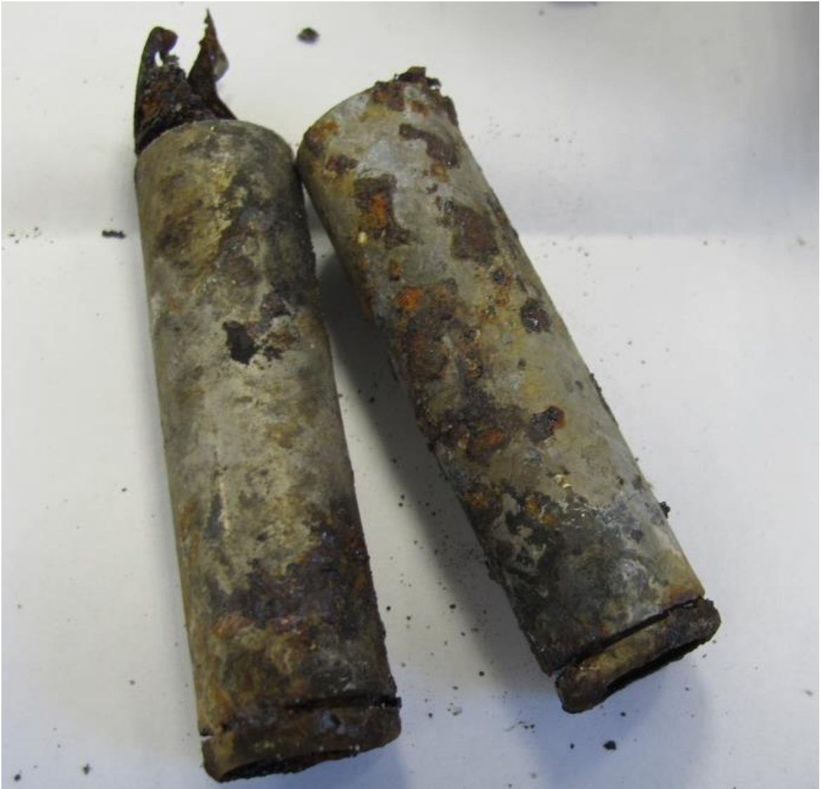
Фото 2. Крупный план поврежденных аккумуляторов.
