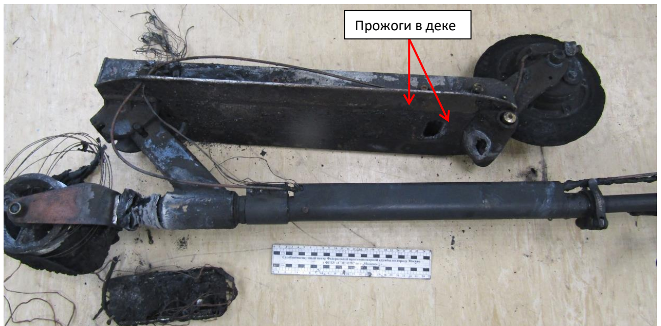
Фото 12. Общий вид электросамоката со следами термических повреждений.
