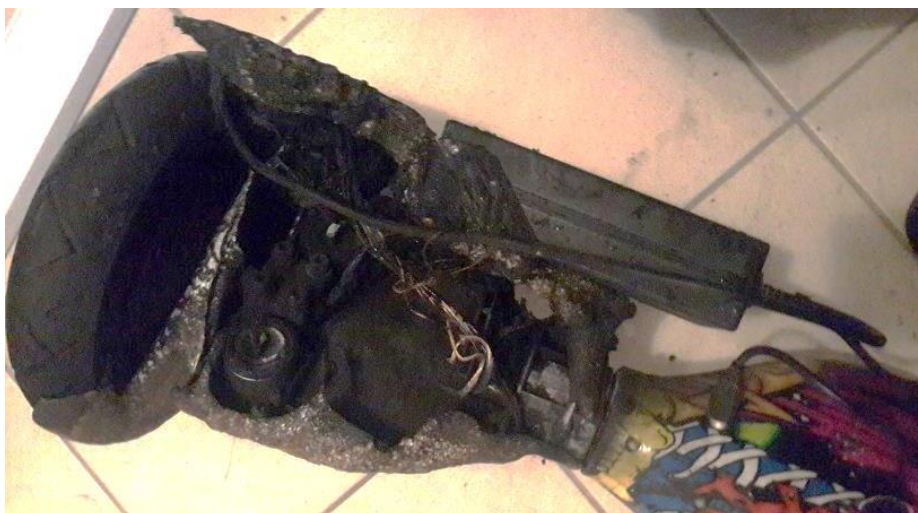
Фото 4. Крупный план поврежденной металлической платформы и корпуса АКБ гироскутера.
