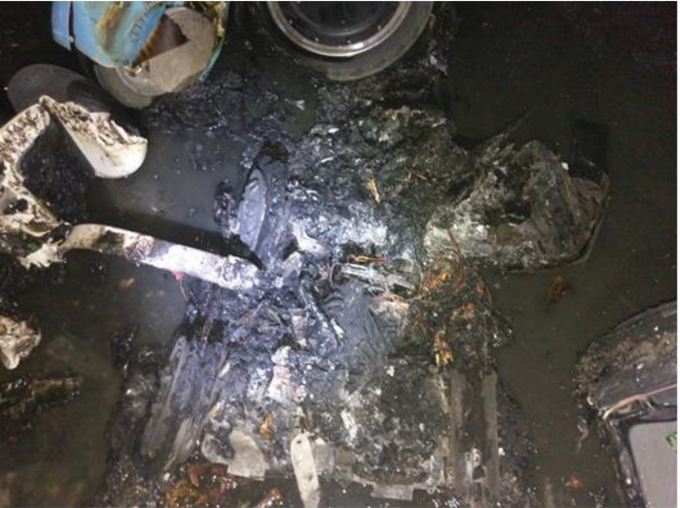
Фото16. Вид выгоревших АКБ электротранспортных средств.
