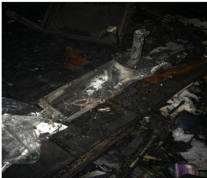
Фото 14. Фрагменты электросамоката в очаге пожара.
