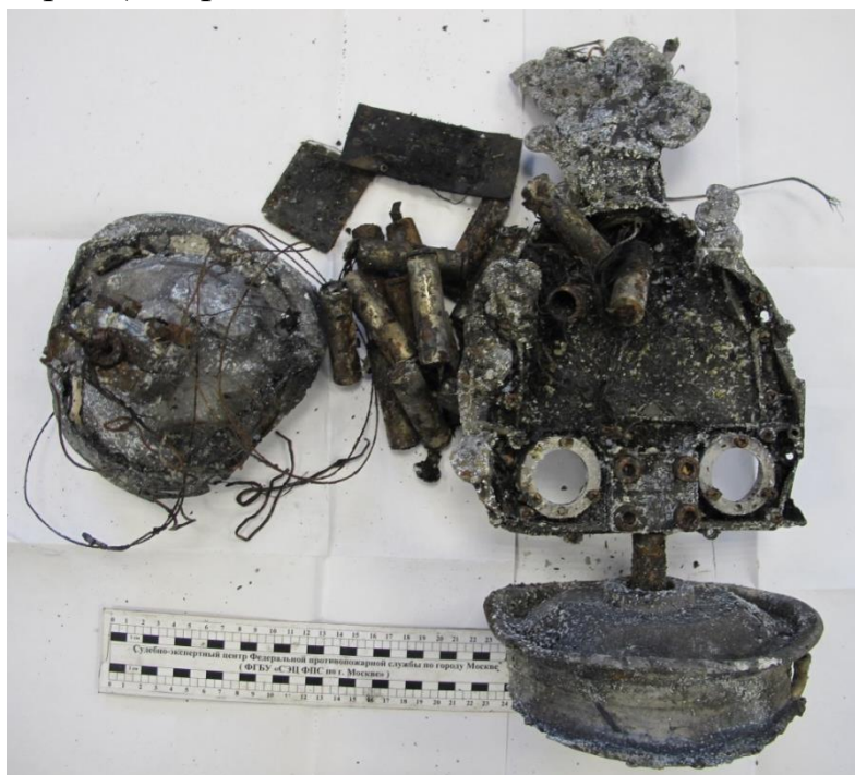
Фото 1. Общий вид представленных остатков обгоревшего гироскутера.
